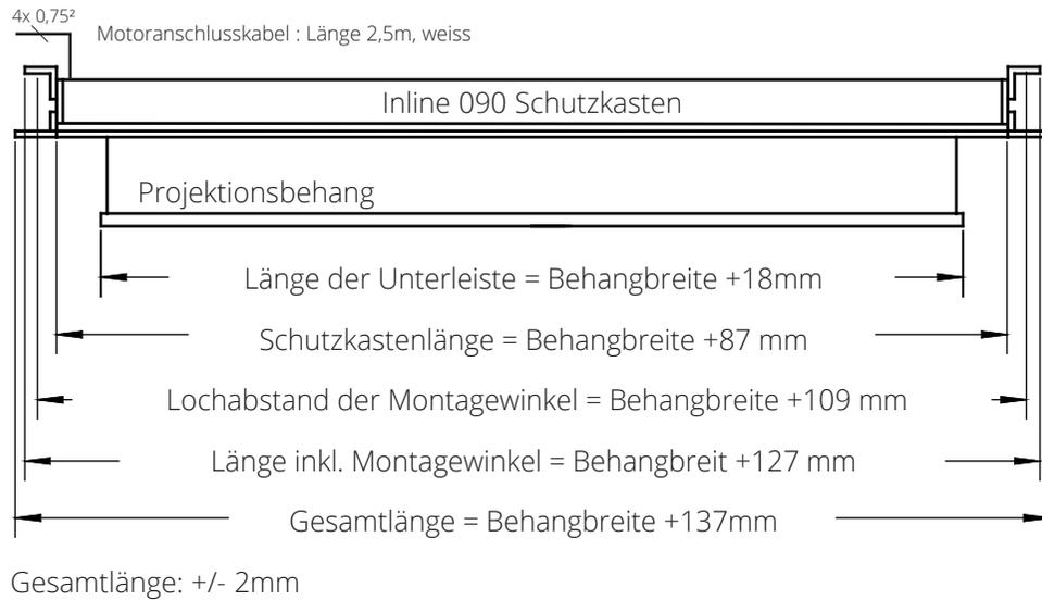
Alle Projektionswände im System Inline sind auch als Version für den Deckeneinbau lieferbar. Für den komfortablen Zugang zu den Befestigungsschrauben bei Montage und Service sind die beiden seitlichen Winkel steckbar. Montage und Demontage der Projektionswand ist ohne zusätzliche Deckenöffnung möglich!
